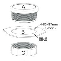
如图B,在仪表安装板上开一个直径为85mm的孔,并确保仪表板后面至少要有55mm的空间.
